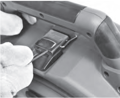
Abbildung 14 – Verschluss unter dem Tragegriff öffnen (mit Sechskantschlüssel)
