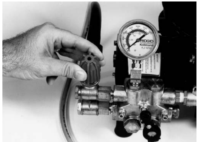
Figura 4 – Regulación de la válvula descargadora
