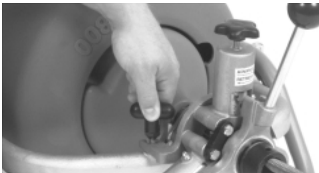
Figure 4 – Montage du système d'avancement automatique sur le cadre
