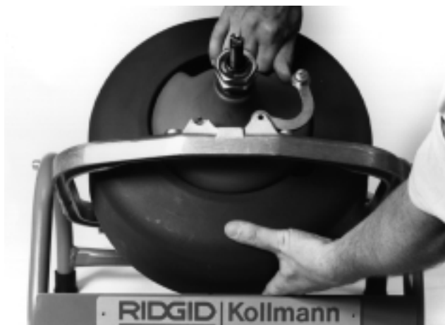
Figure 2 – Alignement du tambour sur la boîte d'engrenages
