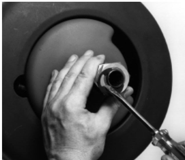
Figure 14 – Enlèvement des cerclips
