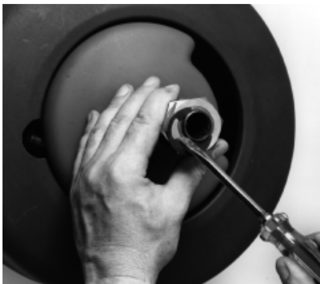
Figura 14 – Extracción de los clips en forma de E
