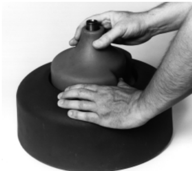
Figura 15 – Extracción del tambor interno
