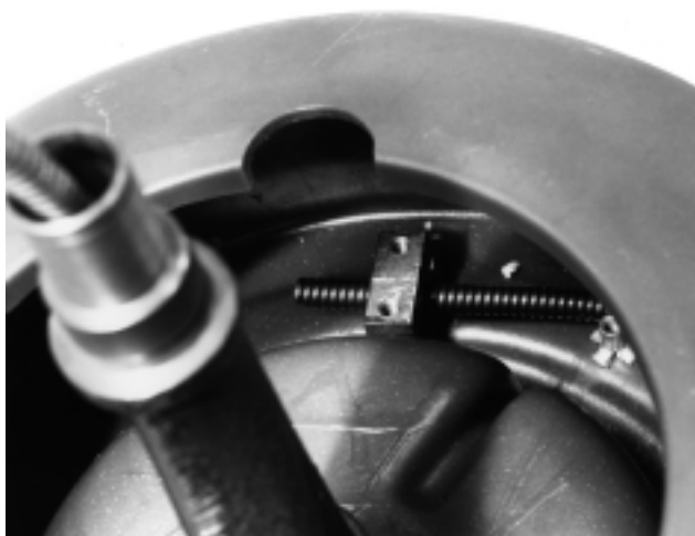
Figure 16 – Position du nouveau câble dans le collier
