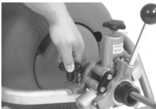
Figura 4 – Montaje de la autoalimentación al bastidor
