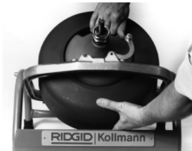
Figura 2 – Alineamiento del tambor con la perforación en la caja de engranajes
