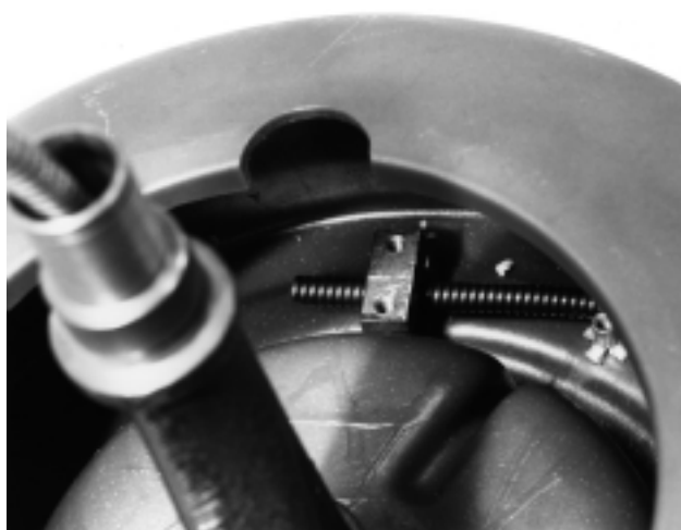
Figura 16 – Coloque el extremo del nuevo cable debajo de la brida
