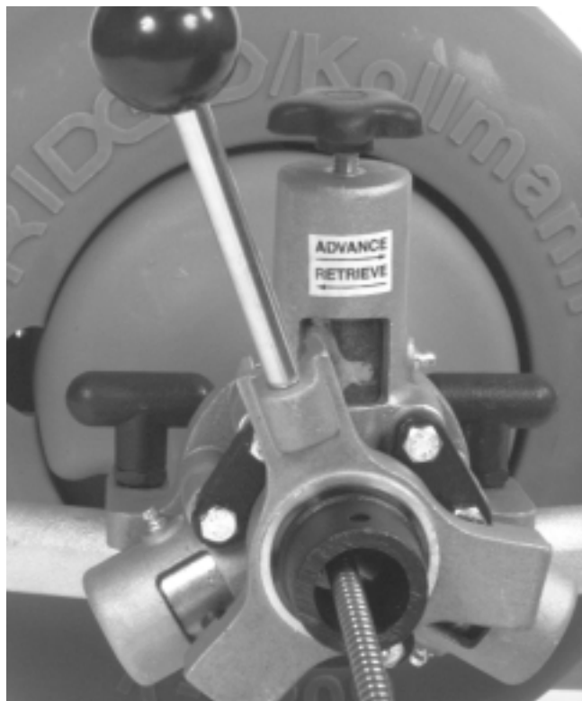
Figure 9 – Système d'avancement automatique en marche arrière
