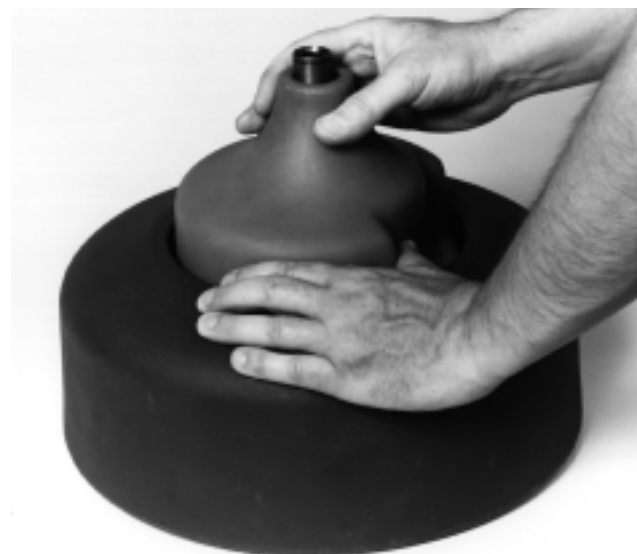
Figure 15 – Dépose du tambour interne
