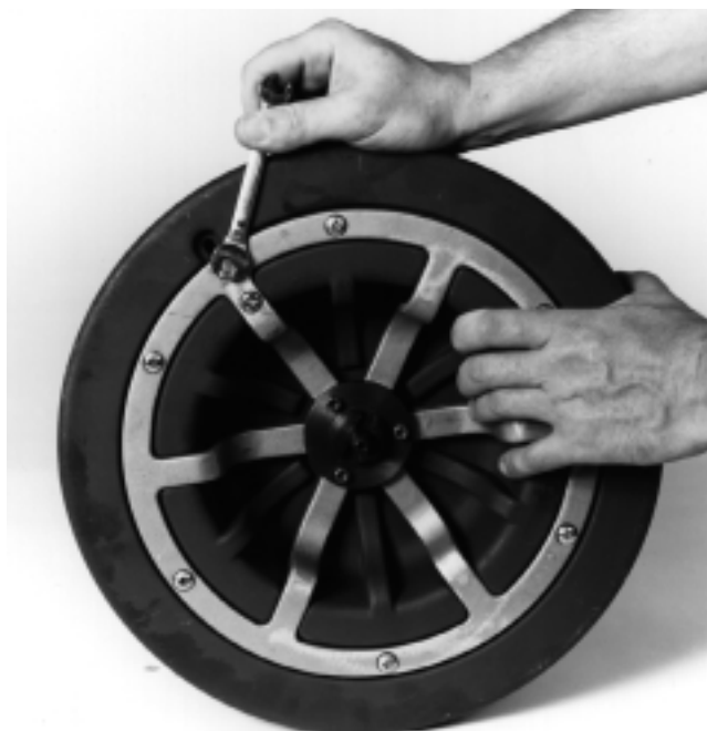
Figure 12 – Desserrage de l'étrier de câble
